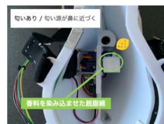
図 3 嗅覚ディスプレイの構造
