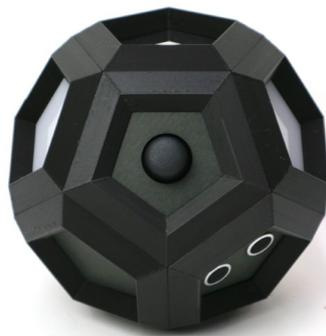
以前制作していたモジュール式のコントローラのモジュールとして、導電性フィラメントとPLAフィラメントの2つの材料を用いてマルチマテリアルプリントすることで、導電性の素材の部分を接触センサーとして、また回路として用い、枠組みの部分をPLAの素材で出力することで接触センサーのモジュールを制作した。
